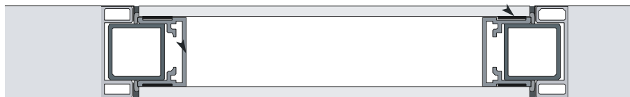
Przekrój poprzeczny zamontowanego pakietu szybowego
